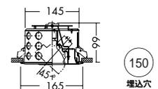
ダイクロハロゲン球(径70mm) 130W形75W(E11) 3,000K
